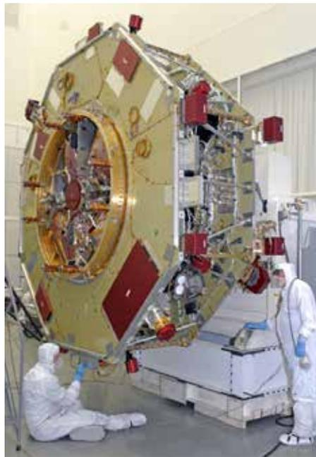
MMS Observatory 1 mit dem ASPOC Instrument © NASA
