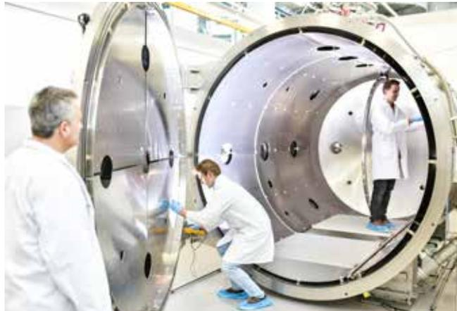
14m<sup>3</sup> große Vakuumkammer der FOTEC, in der Weltraumbedingungen nachgestellt werden.
